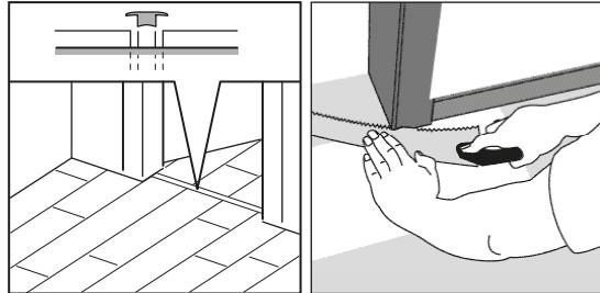
Обратите внимание, что при укладке в SPC полов в помещениях большой площади расширительный профиль (порожек) необходимо устанавливать через каждые 20 метров длины. Также порожек необходимо устанавливать в дверных проемах и в местах примыкания SPC полов к другим покрытиям. Под профилем (порожком) должен быть зазор в 4 мм.
