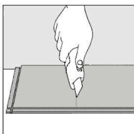
С помощью ножа разрезать
