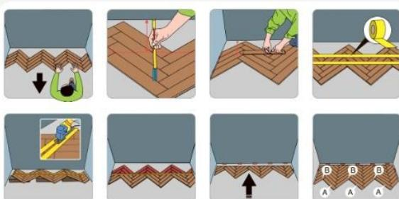
Сдвиньте уложенные ряды в направлении стены и наметьте линию разреза по всему ряду, чтобы выровнять покрытие и подогнать его по стене.
