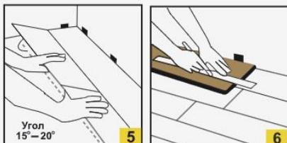
Чтобы соединить вставьте второй ряд под углом 15° - 20° градусов в паз первого ряда. Осторожно опустите и зафиксируйте ряд. Продолжайте укладку последующих рядов таким же образом. Внимание! При укладке второго и последующих рядов обязательным условием является наличие сдвига. Минимальный допустимый сдвиг - 30 см. Рекомендуется монтаж напольного покрытия "в пол доски". Такой вид укладки делает соединения более прочным.
