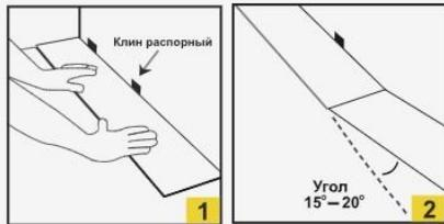
Укладка первого ряда начинается с угла помещения. Расположите планку пазами замка к себе. Используйте распорные клинья для поддержания зазора 8 мм между стеной и полом.
