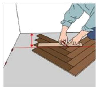
Сдвиньте установленный пол в сторону стартовой стены и проведите линию разреза через весь ряд, параллельно стене. Добавьте номера к доскам, прежде чем разблокировать их, и разрежьте каждую доску отдельно. Затем верните их в правильном порядке к стене.
