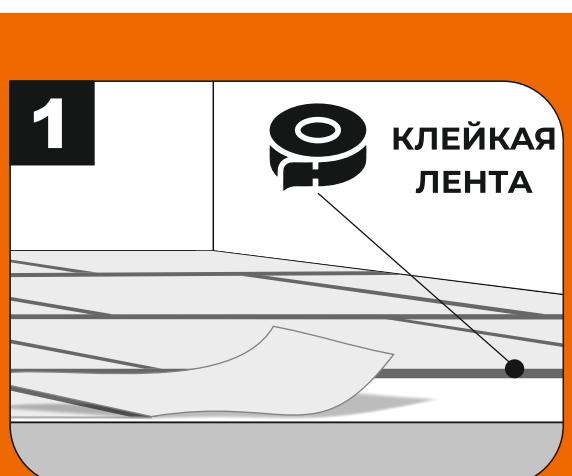
**7.1** Для обеспечения комфорта при эксплуатации расстилается плотная подложка толщиной 1,5 мм. Подложка укладывается встык и закрепляется при помощи клейкой ленты по всей длине стыка.
