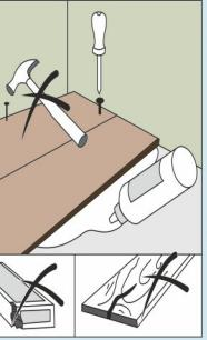
Так как ламинат укладывается плавающим способом, то есть панели ни к чему образом не должны быть прикреплены к основанию, соответственно СТРОГО воспрещается жесткое крепление панелей к основанию при помощи гвоздей, клея и т.д.
