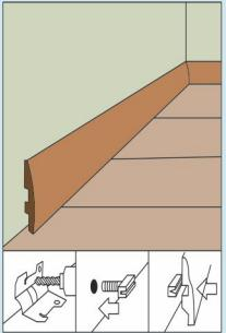
После укладки ламината можно приступить к монтажу плинтуса. Здесь приведена схема крепления плинтуса на клипсах.
