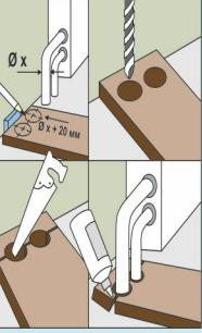
Данная схема позволяет наглядно представить, каким образом можно решить проблему обхода трубы отопительной системы.
