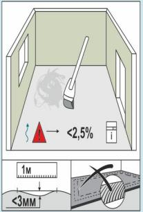
Укладка ламината допустима на линолеум, паркетную доску или иное основание при условии соблюдения требований ровности, прочности и влажности оснований для укладки ламината. Не желательна укладка ламината поверх коврового покрытия из-за эффекта «статического разряда». Если укладка производится на бетонное основание, то относительная влажность не должна превышать 2,5%. Все неровности стяжки, превышающие 3 мм на 1 м. д., должны быть устранены. Основание должно быть чистым, сухим, ровным и прочным.
