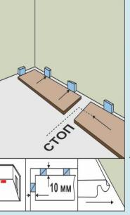
Укладка ламината начинается с формирования первого ряда из 2-ух досок, при этом устанавливаются специальные распорные клинья, обеспечивающие зазор между ламинатом и стеной от 7 до 15 мм. Данные зазоры необходимы для того, чтобы ламинату после укладки не мешала стена расширяться и сужаться. Если Ваш ламинат встал «дубом», то очень велика вероятность, что нарушен именно это правило. Ламинат укладывается замком на себя для облегчения защелкивания панелей.
