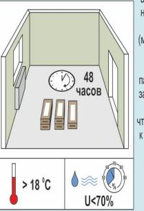
Прежде, чем приступать к укладке, ламинат должен вылежаться в середине комнаты в течение 48 часов при стабильной температуре (минимум 18°C) и относительной влажности более 70%. Обратите внимание: все пачки ламината должны быть запечатаны. Данная процедура необходима для того, чтобы ламинат адаптировался к условиям будущей укладки.
