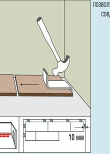
Для монтажа последней доски, примыкающей к стене используется струбцина. Она позволяет без труда осуществить соединение с предыдущей панелью.
