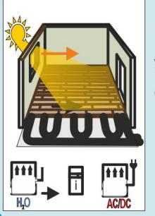
Начните укладку таким образом, чтобы свет из окна падал параллельно швам ламината. В случае перпендикулярного падения света, швы от ламината будут видны более отчетливо. Укладка ламината возможна на основании с водяным обогревом и электрическим.
