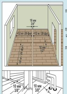
При укладке ламината большими пластами необходимо помнить, что если площадь укладываемого ламината превышает по длине или ширине 12 м и составляет более 120-150 м<sup>2</sup>, необходимо предусмотреть компенсационные швы минимум 12 мм шириной. В противном случае в пополне ламината начнут образовываться щели и напольное покрытие придется в негодность.
