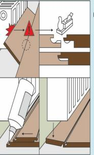
Иногда в укладке ламината возникает ситуация невозможности установки панели из-за помехи. В этом случае необходимо спилить часть замка и закрепить панель при помощи клея для ламината.
