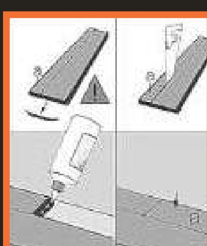
При укладке панелей вокруг дверной рамы необходимо оставить монтажные деформационные зазоры не менее 10 мм. Дверная рама также может быть подрезана и панель помещена под неё.
