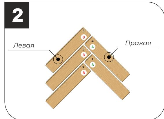
**7.2.2** Тщательно проверяйтестыки между плашками на отсутствие зазоров после добавления каждой следующей.
