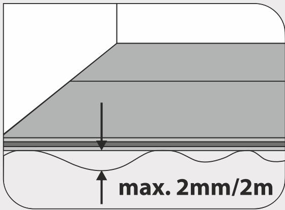
**4.7** При проверке выравнивающего слоя контрольным 2-метровым правилом, передвигаемым во всех направлениях, необходимо проводить не менее девяти измерений на каждые  $50 - 70\text{ м}^2$ . Отклонение поверхности выравнивающего слоя от плоскости **не должны превышать 2 мм.**
