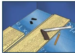
3. Разверните последнюю доску ряда так, чтобы ее гребень оказался напротив гребня предыдущей доски. Подгоните торец последней доски к стене. Отметьте карандашом линию отреза с отступом на 8-10 мм от края предпоследней доски для создания компенсационного зазора.
