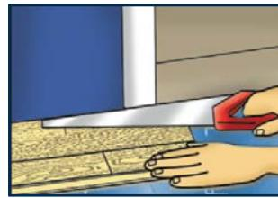
12. Дверные коробки можно снять и отставить в сторону, но их также можно подпилить. Используйте обрезок доски в качестве шаблона для отметки линии отреза. Подпишите дверную коробку мелкозубчатой пилой. Заведите доску под коробку. Проследите за тем, чтобы доска не оказалась зажатой между основанием и дверной коробкой.
