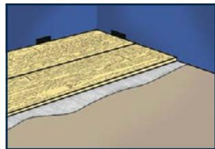
7. Расположите торец следующей доски под углом и соедините торцы. После этого надавите на длинный край доски так, чтобы гребень вошел в паз. Не прижимайте доску к клею. Продолжайте укладку тем же способом до конца ряда.
