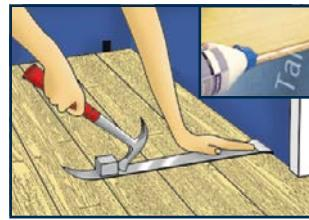
9. Нанесите клей тонкой полоской на верхний край боковой поверхности со срезанным гребнем. Затем подгоните доску с боковой стороны с помощью тягового стержня. Вставьте обрезок в компенсационный зазор между полом и стеной. Теперь, когда пол уложен, можно приступить к установке плинтусов и накладок на стыки.
