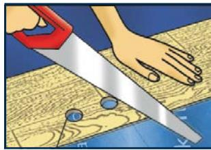
10. Если длинная сторона доски упирается в трубу, просверлите отверстие диаметром, превышающим диаметр трубы примерно на 16 мм, для создания компенсационного зазора вокруг трубы. Отметьте карандашом линию отреза. Отпишите кусок доски, который будет располагаться за трубой ближе к стене. Держите пилу под углом, как показано на рисунке. Если в трубу упираются короткая сторона доски, вставьте пилу в отверстие и пилите под углом 90°.
