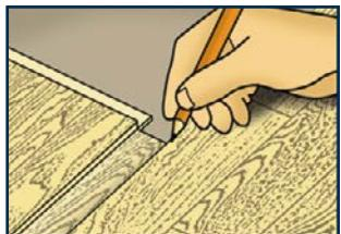
3. Разверните последнюю доску ряда так, чтобы ее гребень оказался напротив гребня предыдущей доски. Подгоните торец последней доски к стене. Отметьте карандашом линию отреза с отступом на 8-10 мм от края предпоследней доски для облегчения укладки.
